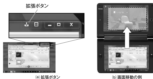
図10. 拡張ウィンドウマネージャ機能 — 拡張ボタンの操作により、アプリケーションのウィンドウを下画面から上画面へ移動させたりできる。
