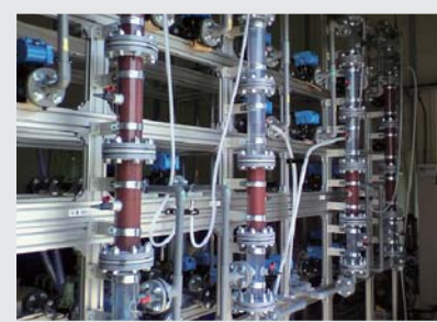
図4. リン回収の実証プラント — 実際の下水処理場において、繰返し型リン吸着剤を用いた下水からの回収試験を進めています。
