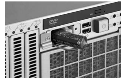
(d) リチウム電池
