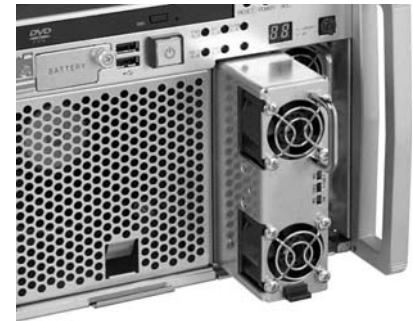
(b) 電源ユニット
