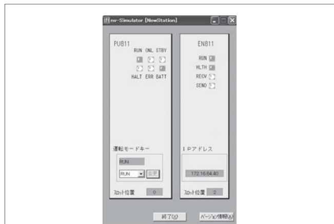
図1. 標準の動作画面 — 実機のLEDに表示している運転モードや、実機のキースイッチの代わりに運転モードを切り替える運転モードキーを画面に表示する。
