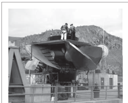
図6. 作業中のウェルズ発電所の水車ランナー—HPSを東芝グループに加え、北米での大規模な改修に対応している。 Runner for Wells Hydropower Station, U.S.A.
