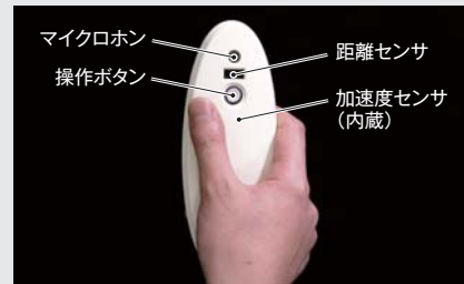
図2. 試作したセンサ内蔵リモコン — 加速度センサと距離センサを内蔵し、ユーザーの自然な発話動作を認識して、適切なタイミングで自動的に音声認識のオンとオフを切り替えます。
