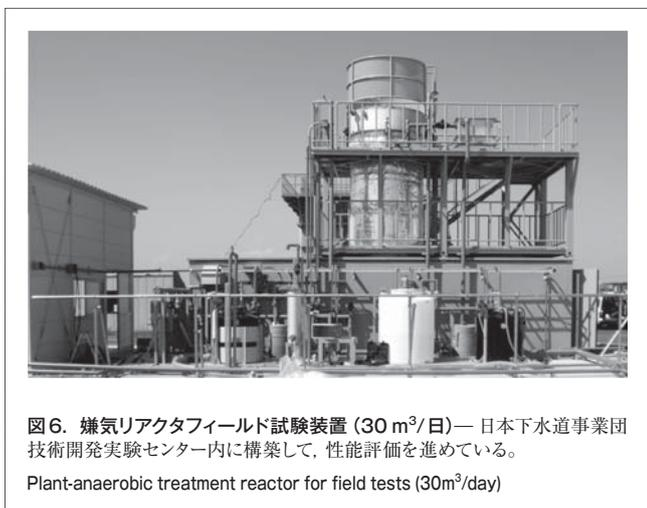
図6. 嫌気リアクタフィールド試験装置(30 m<sup>3</sup>/日)―日本下水道事業団技術開発実験センター内に構築して、性能評価を進めている。
