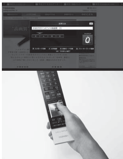
図8. タッチパッドを使った手書き文字入力 — CELLレグザでは、タッチパッド上に指で文字を書くことで、文字を入力することができる。
