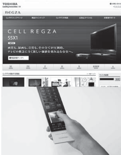
図7. タッチパッドを使ったインターネット画面でのポインタ操作の例 — CELLレグザでは、リモコンのタッチパッドに指を触れることにより、インターネット画面やEPGのポインタやカーソルを操作することができる。
