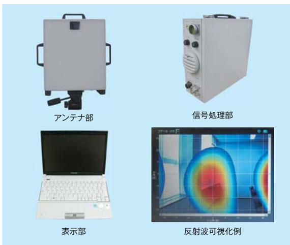
無線LAN用の電波発射源可視化装置と電波可視化例
