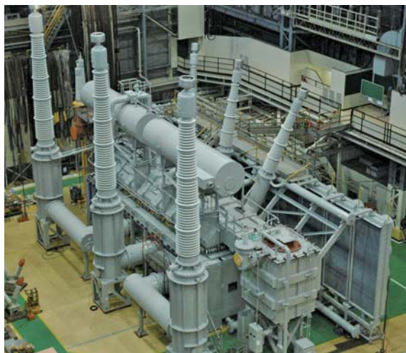
525 kV-1,500 MVA ASA 変圧器
