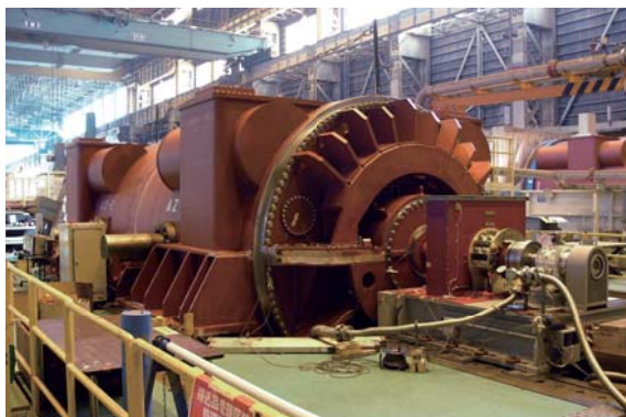
工場における回転電気試験中の一次発電機
