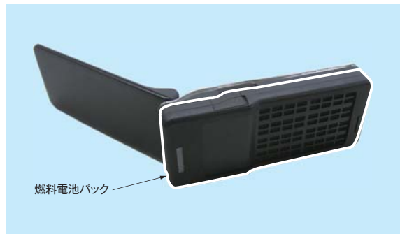
ダイレクトメタノール形燃料電池パックを搭載した携帯電話試作機
