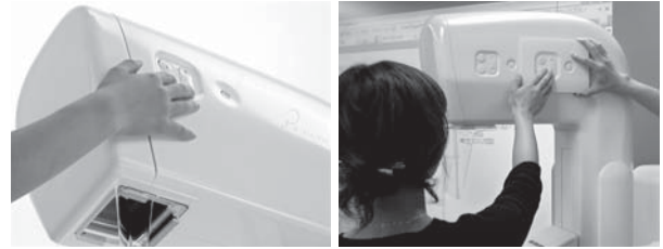
図5. 触知性を高めた操作部と、開発段階における検証のようす — 技師が操作するスイッチ類は、楽な姿勢で操作でき、一度手を添えればその後はスイッチを見なくても操作できるようにした。
