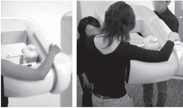
図3. アームレストと、開発段階における形状評価のようす — 受診者を自然にリラックスした姿勢に導くよう形状を検討した。
