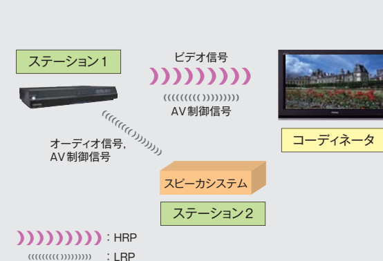
図4. WirelessHD™の二つの物理層 — ビデオ信号などを伝送するHRPとAV制御信号などを伝送するLRPにより、ネットワークの管理を行いAV信号伝送の品質を確保します。
