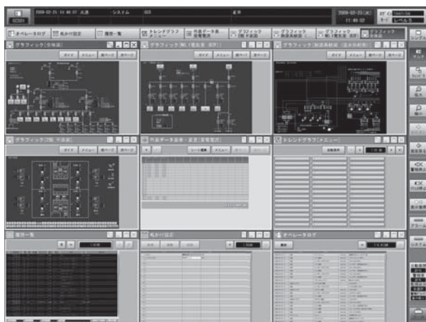
図3. マルチウィンドウ機能の画面例 — グラフィックなど各種の機能を持つ画面を最大9画面まで同時に表示でき、複数画面を自在に組み合わせて監視ができる。
