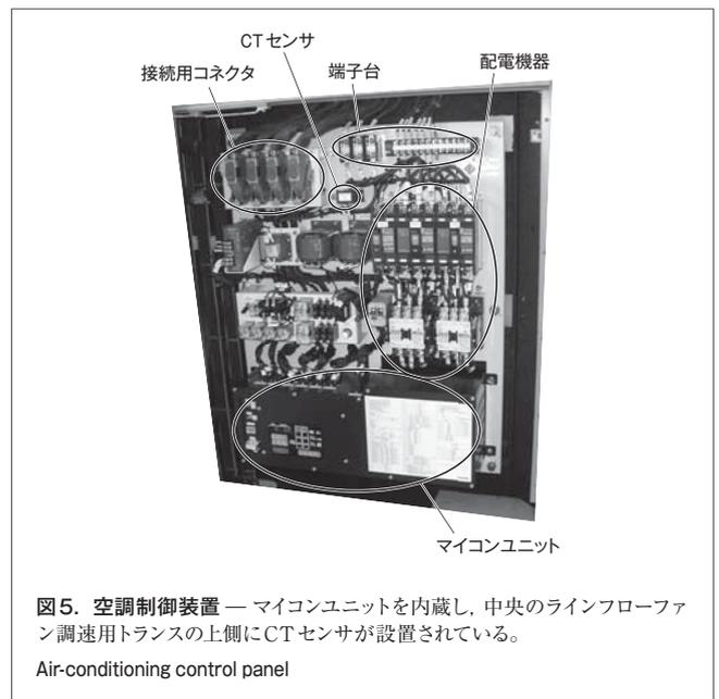
図5. 空調制御装置 — マイコンユニットを内蔵し、中央のラインフローファン调速用トランスの上側にCTセンサが設置されている。
