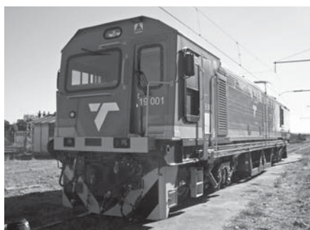
図3. 19E形 交直両用電気機関車 — 交流 25 kV 及び直流 3 kV の2種類の架線電圧に対応している。
