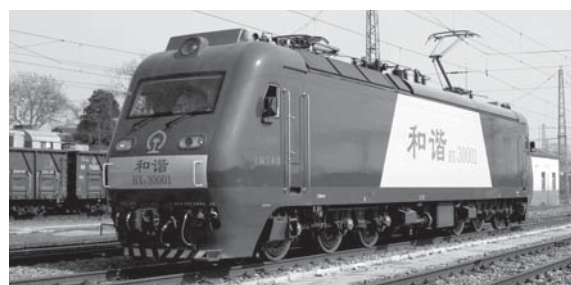
図1. HXD 3 形 交流電気機関車 — 機関車踏面出力7,200 kWの大容量機関車である。
