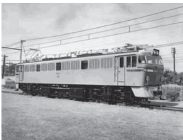
図5. 交流電気機関車ED72 — 試作車を昭和36年に製造、昭和37年からは量産車20両を製造し、鹿児島本線の輸送力増強に貢献した。 Type ED72 AC electric locomotive
