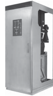
図7. 固体絶縁スイッチギヤ — 従来、空気やSF 6 ガスで絶縁していた閉鎖配電盤内蔵機器をエポキシで絶縁構成したものである。高度な製造技術が必要であり、現在36 kVクラスまで製品化を実現している。
