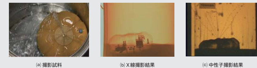
図5. カラー I.I. TM による撮影例 — プリキ缶の中に入っている樹脂製の噴水のがん具を(a)に示します。これをX線で撮影した結果を(b)に、中性子で撮影した結果を(c)に示します。X線撮影では水の中と樹脂の中のモーターや電池が見えていますが、噴水の水が飛んでいる状態は見えません。中性子撮影では、水や樹脂の中は見ることができませんが、透明なガラスの中を見ているように噴水の水を見ることが出来ます。
