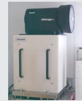
図4. 中性子カラー I.I. TM — 中性子照射室内には、入力面のサイズが9インチの黒い中性子カラー I.I. TM 本体（商品名：Ultimage™）と、遮へい容器に入った白いカラーカメラシステムが設置され、照射室外のモニターで観察します。
