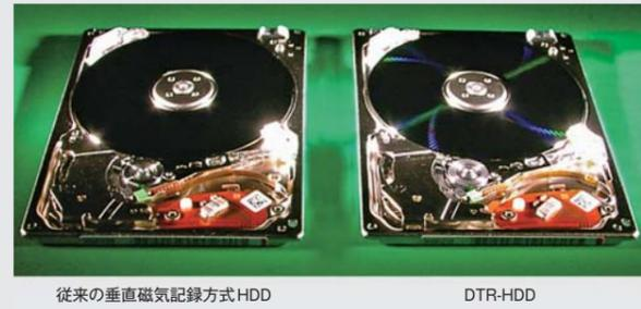
図1. 従来の垂直磁気記録方式HDDとDTR-HDD — 従来の垂直磁気記録方式HDDと比較し、DTR-HDDはディスク表面に微細パターンを持つため、パターンからの干渉光が見えます。
