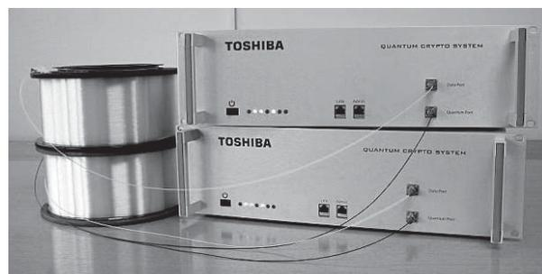
図1. QKDを用いた秘匿リンク通信システム — 送受信器間の暗号鍵配信にQKDを利用することで、安全かつ頻繁な鍵更新を実現している。
