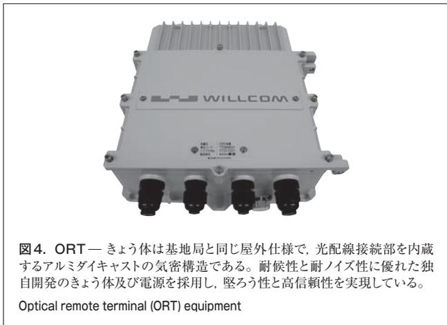
図4. ORT — きょう体は基地局と同じ屋外仕様で、光配線接続部を内蔵するアルミダイキャストの気密構造である。耐候性と耐ノイズ性に優れた独自開発のきょう体及び電源を採用し、堅ろう性と高信頼性を実現している。
