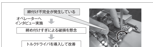
図10. 組立て不具合の改善事例（その1）— トルクドライバの導入により、作業者の締め付けリスク不安を軽減し、不完全な締め付けを削減した。
