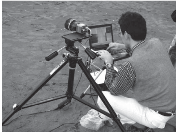
図9. 1 km地点での受信実験のようす — 受信装置は、CMOSカメラと画像受信処理装置で構成され、撮像対象から可視光を受信し、受信情報を表示したことを確認した。
