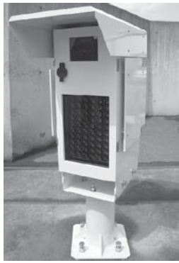
図2. 撮像部の外観 — 撮像部はカメラ及び照明装置から構成され、処理部は別装置に収納されている。
