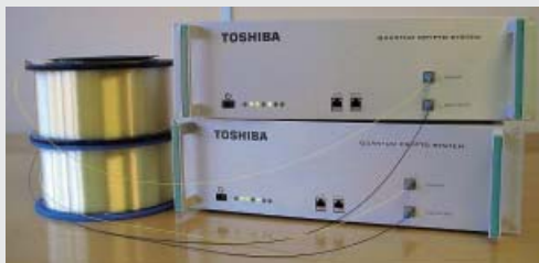
▲ ウィーンでのQKDネットワーク実証試験に用いたQKDシステム QKD system used for QKD network field test in Vienna
