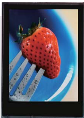
◀ 低消費電力、長寿命化を実現した低分子タイプ有機ELディスプレイ Organic electroluminescence (EL) display with low power consumption and long life
