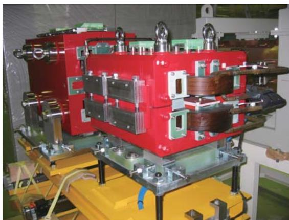
スキャニング照射用電磁石システム
