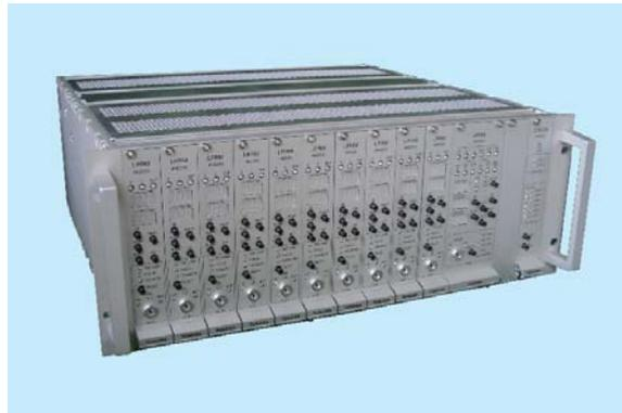
FPGAを使用した中性子計装装置
