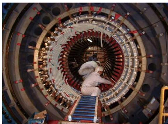
タービン発電機の固定子コイル巻替え作業
