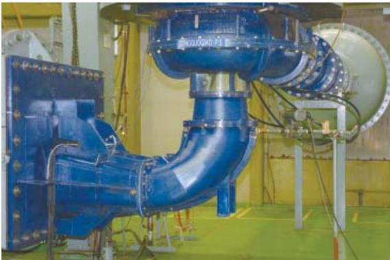
中国 功果橋発電所向け水車模型試験装置
