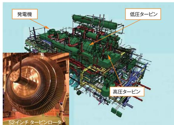
AP1000向けタービン、発電機の配置(鳥観図)とタービンローター
