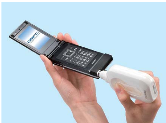
燃料電池を搭載した携帯電話試作機 Prototype direct methanol fuel cell (DMFC)-powered cellular phone
