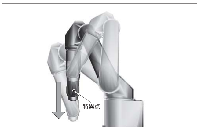
図10. 特異点通過 — 特異点処理機能により, 特異点を通したり, 特異点近傍で安定かつ滑らかに動作することができる。
