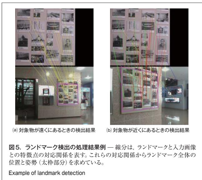
は4段階で、各段階が20本、高さ15の木で構成されている。距離が1.4～4.0 mの範囲でのランドマークの検出と、距離及び姿勢の計測が可能であることを確認した。
