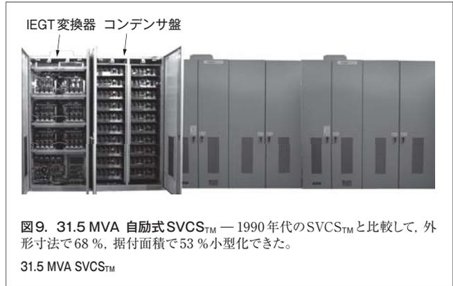
図9. 31.5 MVA 自動式SVCS<sub>TM</sub> — 1990年代のSVCS<sub>TM</sub>と比較して, 外形寸法で68%, 据付面積で53%小型化できた。
