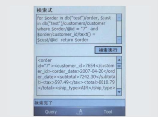
図4. モバイル端末上での動作—数Mバイトのメモリ使用量で、数百MバイトのXMLデータを検索することができます。
