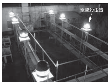
図8. 高UVカット膜付きメタルハライドランプの誘虫性確認試験 — 当社横須賀事業所内に電撃殺虫器を設置し、その中で夜間ランプを点灯し誘虫性の確認試験を行った。
