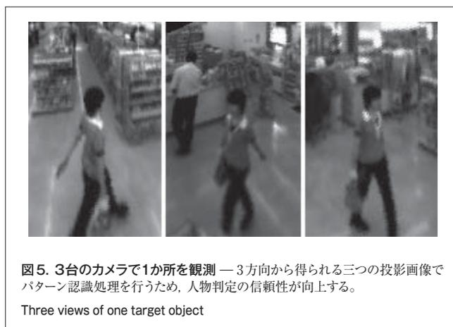
視体積交差法で検出される移動物体の候補位置において3方向から見た投影画像を作り、それぞれの画像上でパターン認識により頭部を検出する。
