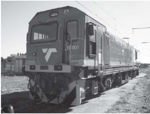
図2. 19E形交直両用電気機関車 — 19E形交直両用電気機関車は、AC25 kV及びDC3 kVの2種類の架線電圧に対応している。
