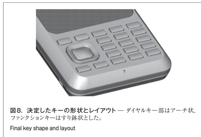
**3.5.2 キー形状** ほとんどすべてのキーは筐体面からの高さを0.7 mmとした。電源キーだけは高さを一段落とすことで、不意な電源のON/OFFを起こしにくくしている。更に、キーの誤入力対策として、筐体の側面にスライド式のキーロックを設けた。
