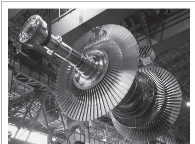
図6. 48 in翼適用低圧ローター — イタリア向け及び中国向けプロジェクトの低圧ローターには、最終段翼に48 in翼を適用している。北米向けプロジェクトには40 in翼を適用している。
