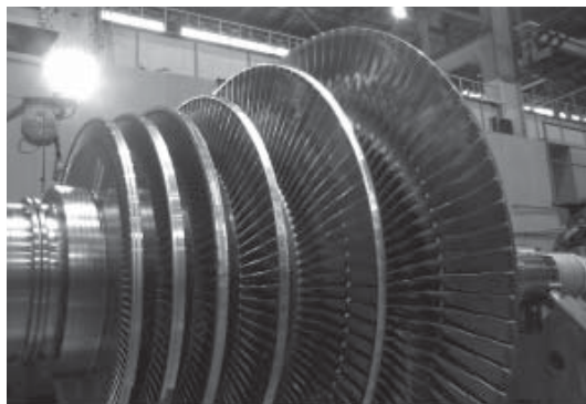
図7. 低圧タービンローター — 新開発の60 Hz用最終段シリーズを採用して設計している。
