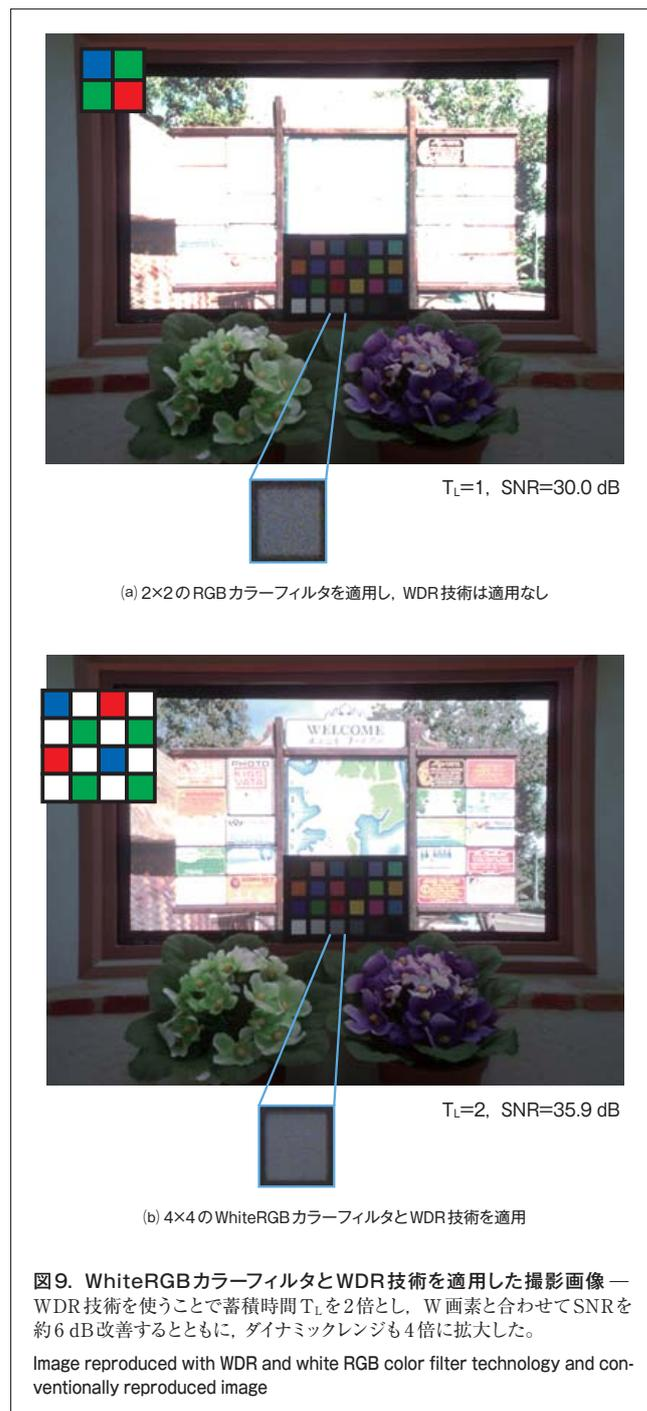
用しないで撮影した画像を図9(a)に、WhiteRGBカラーフィルタとWDR技術を適用して撮影した画像を図9(b)に示す。G信号のSNRは、蓄積時間 $T_L$ を2倍に増加することでショットノイズを3 dB改善し、W画素の効果と合わせて約6 dB改善できた。ダイナミックレンジは4倍に拡大している。
