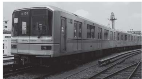
図1. 01系車両 — 01系試験車両に、直流 (DC) 架線600 Vを電源とする PMSM 主回路システムを搭載した。
