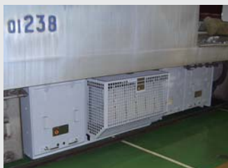
▲ 永久磁石同期電動機 Permanent-magnet synchronous motor
