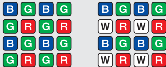
▲従来のBayerカラーフィルタ配列(左)とWhite-RGBカラーフィルタ配列(右) Bayer color filter array (left) and white-RGB color filter array (right)
