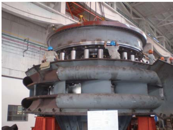
水車静止部の工場での仮組立
