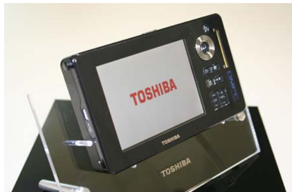
燃料電池を内蔵したポータブルメディアプレーヤ gigabeat TM 試作機
