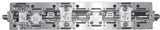
図7. ドライバ段アンプの内部 — GaN 電力 HEMT を2素子内蔵している。
