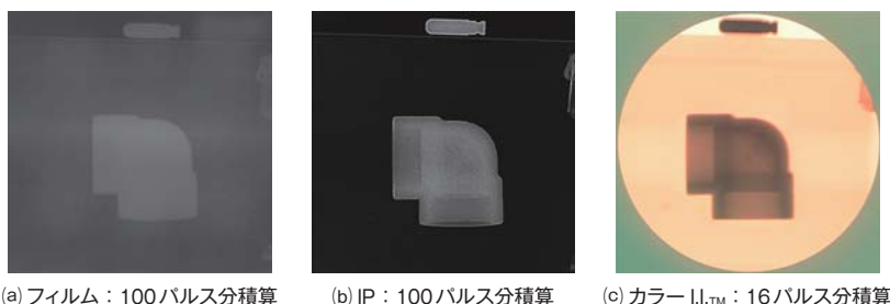
図5. パルス照射型X線源による保温材内のエルボの撮影結果 — X線の管電圧270 kVでパルス照射することにより、フィルムやIPでは100パルス分積算しても見えないエルボ内部を、カラーI.I. TM では1パルスから確認できる。粒状性を良くするために16パルス分積算して表示している。
