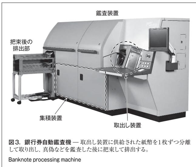
図3. 銀行券自動鑑査機 — 取出し装置に供給された紙幣を1枚ずつ分離して取り出し、真偽などを鑑査した後把束して排出する。
