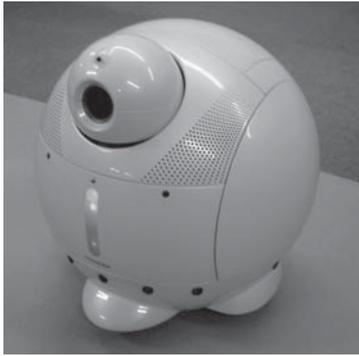
図1. ホームロボットApriAlpha™ — カメラとリモコンを備えたホームロボットApriAlpha™が、家庭内の監視と家電の制御を行う。
