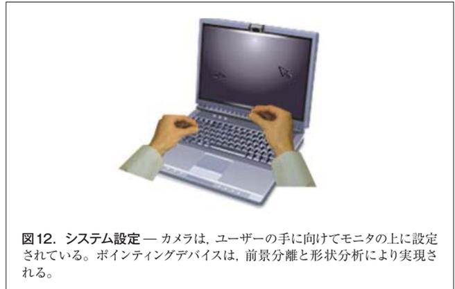
図12. システム設定 — カメラは、ユーザーの手に向けてモニタの上に設定されている。ポインティングデバイスは、前景分離と形状分析により実現される。
